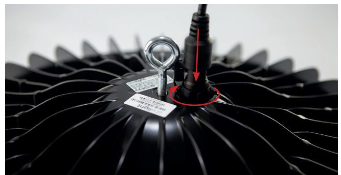
Abb. 5: IP 67-Stecker in die Kupplung einstecken, festschrauben
